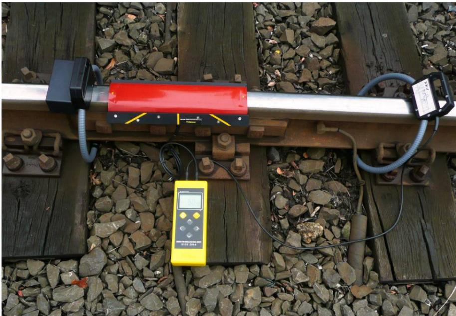
Abb. 3.5 C-Sensor hinter dem nächsten abzweigenden Leiter
