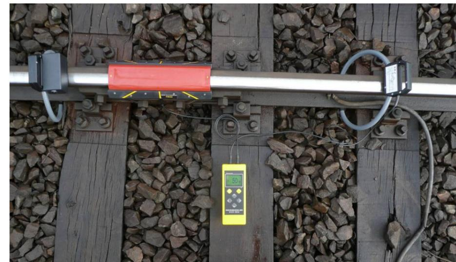
Abb. 3.7 C-Sensor umschließt Schiene und einen Leiter
