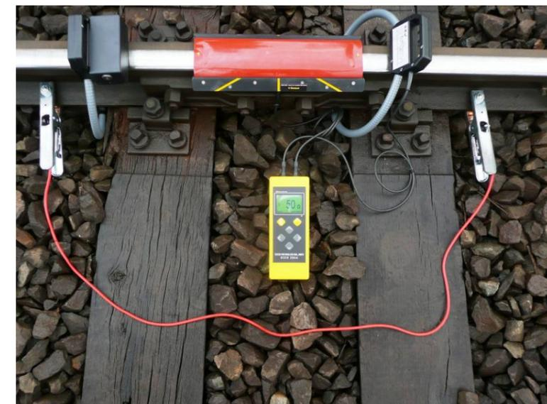
Abb. 3.2 SICO 2046 mit parallelem Kurzschluss
