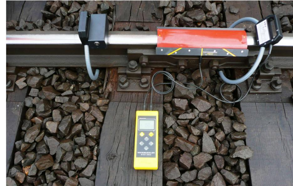
Abb. 3.6 C-Sensor umschließt Schiene und Isolierstoß
