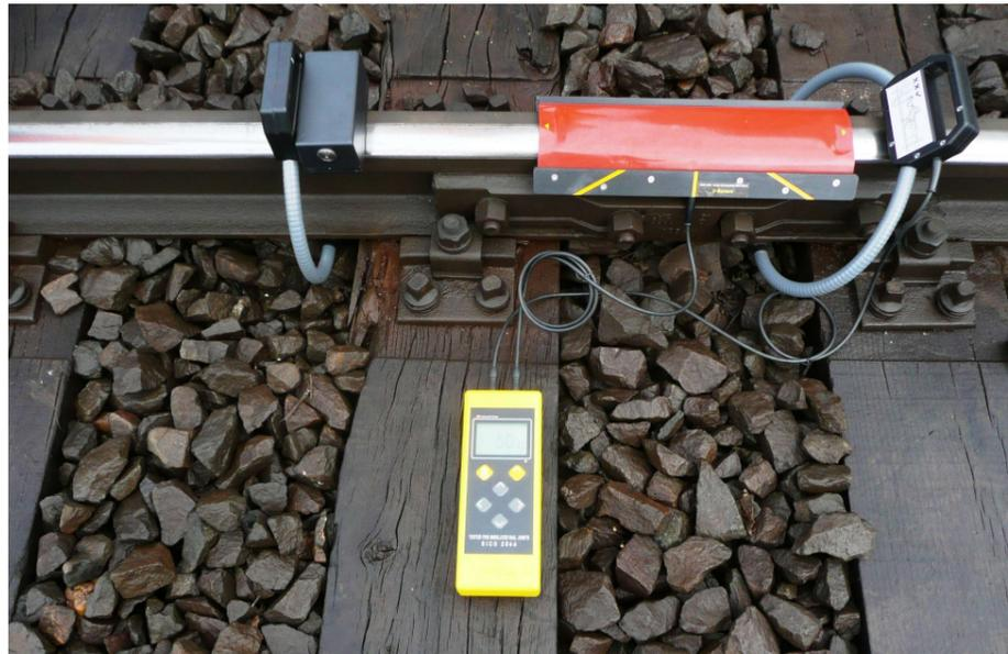
Abb. 3.8 C-Sensor umschließt Schiene und Isolierstoß
