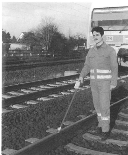
Bild 2: Signalsonde mit Fühler und Auswerteelektronik
